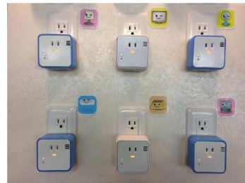
コンセントと連動して、電気使用量を測定
